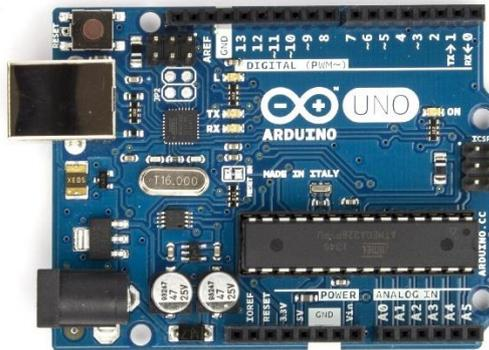
Gambar 2. 3 Mikrokontroler Arduino Uno [5].
