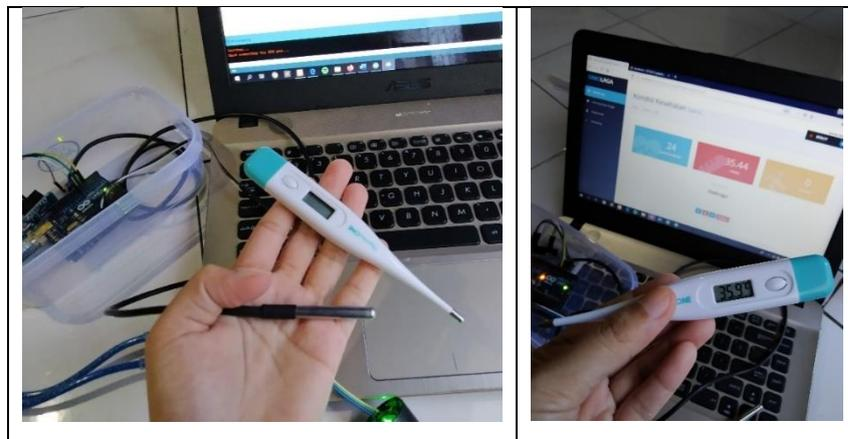
Gambar 4. 17 Pengujian sensor DS18B20.
