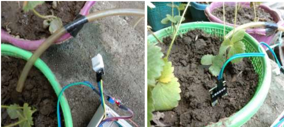
Gambar 4. 3 DHT22 dan Soil Moisture Sensor
